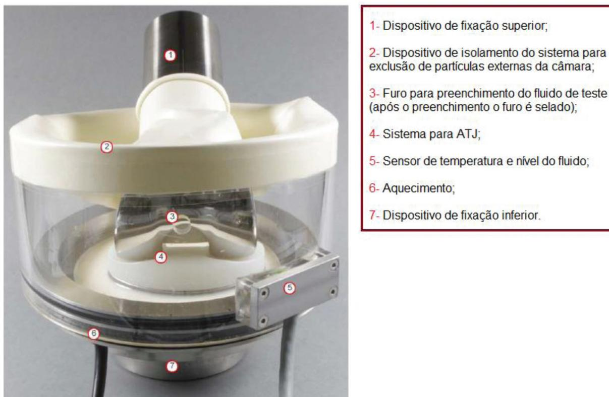
**Fig. 1** Representação da câmara de teste individual.
