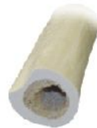
Mostra de abertura pela fresagem
