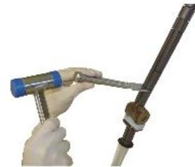
Dispositivo para desencaixe das módulos
